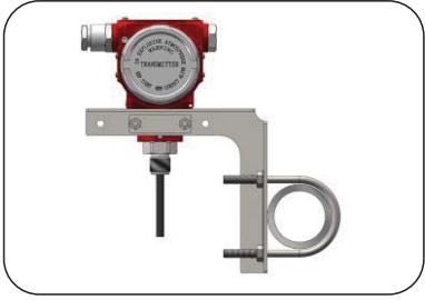
带接线盒的压力变送器可以选用支架来固定和支撑整个产品。一般情况下，要求接线盒的安装位置高于地面最少1.5米，如在地下环境安装，应选用厂家配套专用电缆连接到控制设备，避免高湿度环境造成接线盒内凝结积液。
