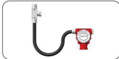
**⚠ 在危险场合安装使用隔爆型压力变送器，应使用金属挠爆管把信号电缆连接到穿线盒，并引到安全区域。**
