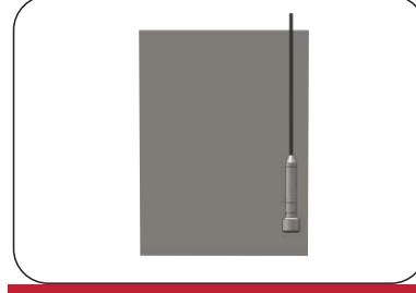
在某些流速过快区域，如无法安装保护管，可采用增加重锤来固定压力变送器，但电缆和金属探头的连接处与介质接触面变大，比较容易被冲刷损坏，应适当增加保护。
